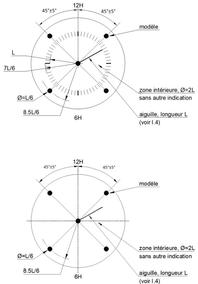
Cotes en mm, tolérances générales  $\pm 200 \mu\text{m}$ , tolérance de concentricité axe aiguille-décalque  $\pm 400 \mu\text{m}$
