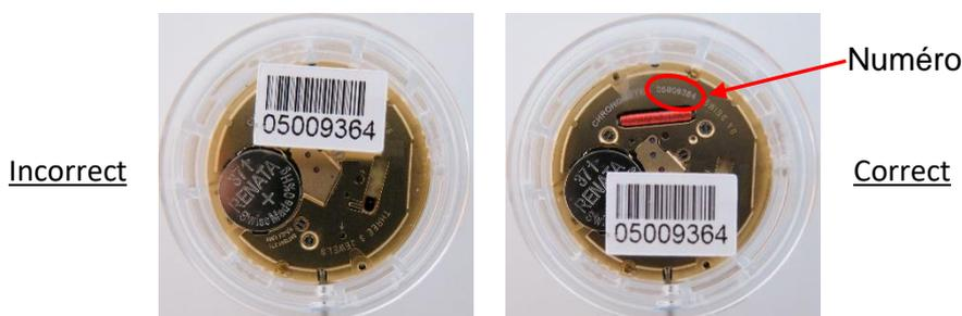
En cas de dépôt de mouvements avec masse oscillante, le déposant devra s'assurer de la bloquer et de ne pas entraver la lisibilité du numéro de mouvement marqué sur la platine.
